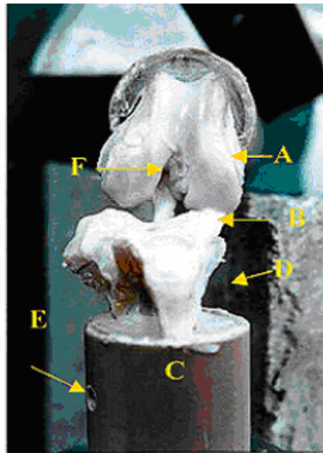
Figura 2_Vista craniocaudal do fêmur (A) e tibia (B) de cão fixados em tubo de PVC (C) com parafuso e resina acrílica autopolimerizável (D) Orifício para passagem do parafuso de fixação da tibia (E) Ligamento cruzado cranial (F)
